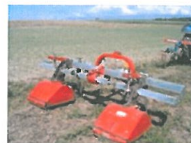
Mekanisk ukrudtsbearbejdning ved hjælp af en rækkefræser.
